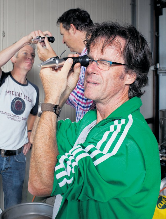
Met een refractometer wordt het suikergehalte van het brouwsel gemeten, aan de hand van de breking van het licht.
